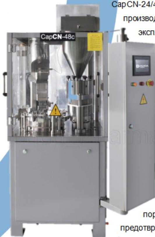
CapCN-24/48C перерабатывает продукты с оптимальной производительностью до 400/800 капсул в минуту, отличаясь низкими эксплуатационными расходами, минимальным временем простоя и общей надежностью производства. При дозировании порошка используется технология трамбовки на 3/6 ступеней для повышения точности. Возможна заправка пеллетами. Затем их переносят в специальные ячейки на роторе. Здесь отделяется капсула, после чего нижняя часть приходит в положение наполнения.
