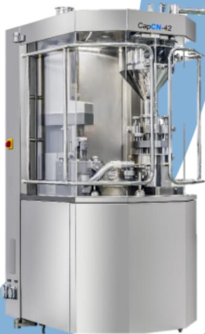
Pro использует передовую международную концепцию дизайна. Благодаря операции очистки полностью автоматическая машина для наполнения твердых капсул дополняется высокоточным дозирующим дисковым наполнительным стержнем напорного типа.
