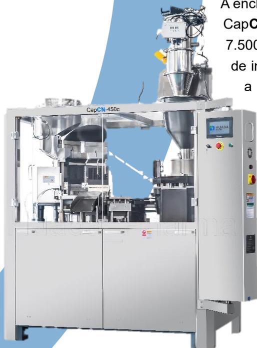
A enchedora automática de cápsulas CapCN-450C processa os produtos para uma produtividade ideal de até 7.500 cápsulas por minuto, com operação de baixa manutenção, tempo de inatividade mínimo e produção geral confiável. A dosagem de pó usa a tecnologia de compactação de 5 estágios para maior precisão. O enchimento de pellets está disponível.
