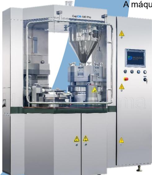
A máquina automática de enchimento de cápsulas de casca dura CapCN -180
