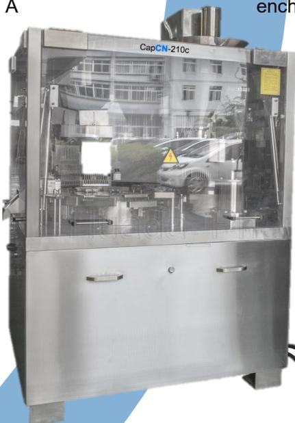
CapCN-210C processa os produtos para uma produtividade ideal de até 3.500 cápsulas por minuto, com operação de baixa manutenção, tempo de inatividade mínimo e produção geral confiável. A dosagem de pó usa a tecnologia de compactação de 5 estágios para maior precisão. O enchimento de pellets está disponível.
