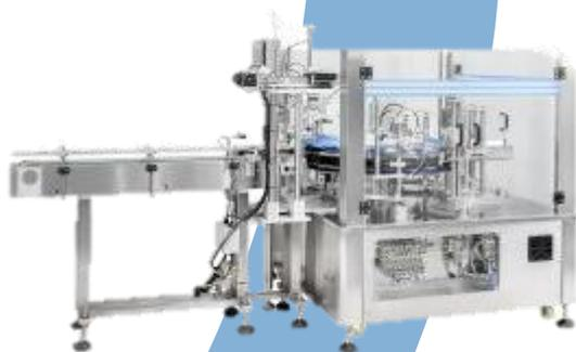
この機械は真空吸引カップを使用してカートンをスターホイールに送り込みます。空のカートンはスターホイールによって折り畳み機構 1 まで回転され、カートンの底がシールされます。梱包される完成品が手でカートンに置かれた後、スターホイールがカートンを折り畳み機構 2 まで回転させ、カートンの上部を密封します。最後に、完成した製品はスターホイールによりカートン押し出し機構へ搬送され、納品されます。
