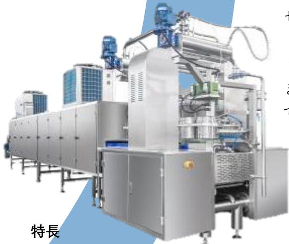
ゼラチンゼリーキャンディの製造装置は、調理部、投入部、冷却部から構成される。GD150 ラインは 1 列の金型を使用し、ピースの重量に応じて 1 時間あたり 100 ~ 150 kg のキャンディを生産できます。キャンディーの形状はお客様のニーズに合わせてカスタマイズでき、さまざまなデザインが可能です。キャンディーは単色または二色、左右または上下のパターンで作ることができます。最終製品の例を以下の写真に示します。
