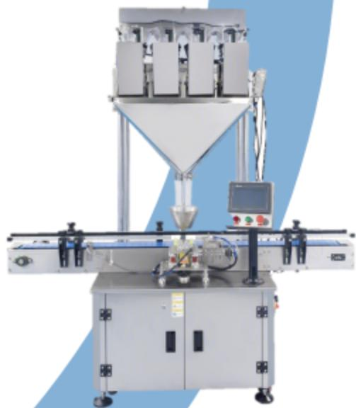
Машина в основном дает обратную связь по взвешиванию в процессе подачи и контролирует скорость подачи, близкую к целевому значению. Связь данной машины осуществляется в режиме шины CAN, процесс взвешивания каждого бункера для взвешивания осуществляется независимо от панели модуля, что сокращает время, занимаемое на связь с материнской платой. Сделайте обратную связь информации о весе и обработку амплитуды проволочной вибрационной машины более быстрой.
