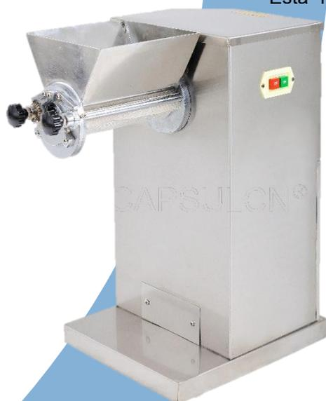
Esta máquina é usada principalmente em comércios como farmácia, indústria química, alimentos, cerâmica e plásticos extensivamente, fazendo partículas de material em pó úmido. Faça o cilindro balançar reciprocamente, extrudando o material da malha da tela para granulação. Também pode ser usado para esmagar os materiais aglomerados em pequenos grânulos diretamente.
