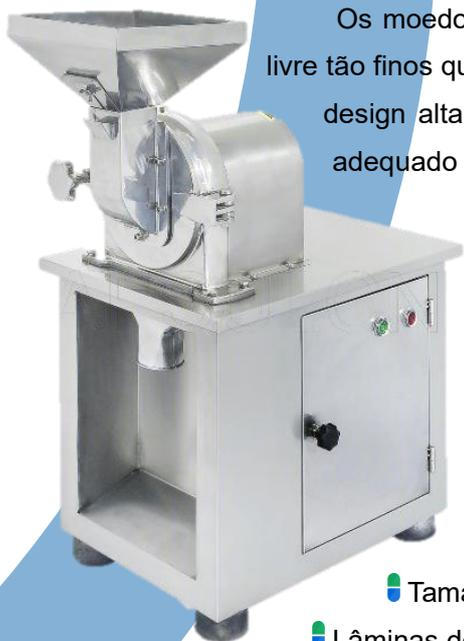
Os moedores finos da série SF são projetados para moer materiais secos e de fluxo livre tão finos quanto 120 mesh com distribuição muito estreita do tamanho das partículas. O design altamente eficiente permite fácil acesso a todos os componentes internos e é adequado para materiais sensíveis ao calor, como resinas e açúcar.
