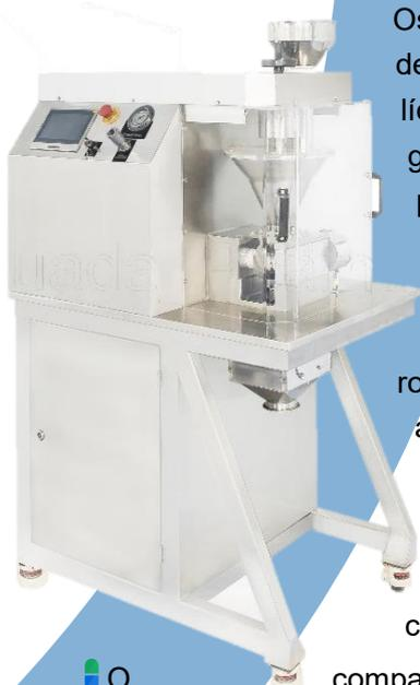
Os granuladores a seco são usados para o processo de granulação a seco. O processo de granulação a seco é utilizado para formar grânulos sem o uso de uma solução líquida, pois o produto a ser granulado pode ser sensível à umidade e ao calor. Formar grânulos sem umidade requer compactar e densificar os pós. Neste processo, as partículas primárias de pó são agregadas sob alta pressão.
