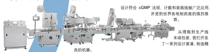
综合设备包括理瓶机、片剂/胶囊计数器、干燥剂插入器、棉花插入器、旋盖机、贴标机、感应封盖机。我们正在提供最佳的集成解决方案,以满足您对生产线的所有要求。
