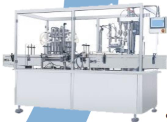
La máquina de llenado de botellas de desplazamiento positivo LiqCN-8S está diseñada para proporcionar una capacidad de llenado flexible para todas sus aplicaciones, desde líquidos ligeros hasta cremas espesas y geles. Los modelos automáticos están disponibles en tres rangos de dosificación: 30-100 ml (hasta 80 cpm), 100-500 ml (hasta 60 cpm) y 500-1000 ml (hasta 50 cpm) con pocas piezas de cambio adicionales.
