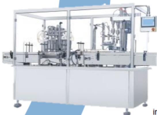
La máquina de llenado de botellas de pistón de la serie LiqCN-4A está diseñada para proporcionar una capacidad de llenado flexible para todas sus aplicaciones, desde líquidos ligeros hasta cremas espesas y geles. Los modelos automáticos están disponibles en tres rangos de dosificación: 0-100 ml (hasta 40 cpm), 100-500 ml (hasta 30 cpm) y 500-1000 ml (hasta 25 cpm) con pocas piezas de cambio adicionales.
