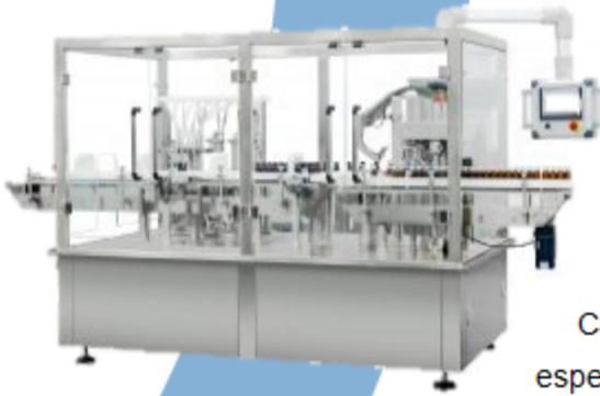
La máquina de llenado de botellas de pistón de la serie LiqCN-4 está diseñada para proporcionar una capacidad de llenado flexible para todas sus aplicaciones, desde líquidos ligeros hasta cremas espesas y geles. Los modelos automáticos están disponibles en tres rangos de dosificación: 0-100 ml (hasta 40 cpm), 100-500 ml (hasta 30 cpm) y 500-1000 ml (hasta 25 cpm) con pocas piezas de cambio adicionales.
