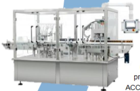
El monobloque de llenado y tapado de botellas LiqCN-4MA está diseñado para llenar y tapar botellas de plástico o vidrio de hasta 35 cpm. Con este sistema Monoblock, el proceso de fabricación se simplifica al combinar la llenadora y la tapadora de botellas en una sola máquina que ahorra espacio. Esta máquina Monoblock es ideal para productos en la industria farmacéutica o alimentaria. Cada sistema ACCUMOST Monoblock se construye específicamente según las
