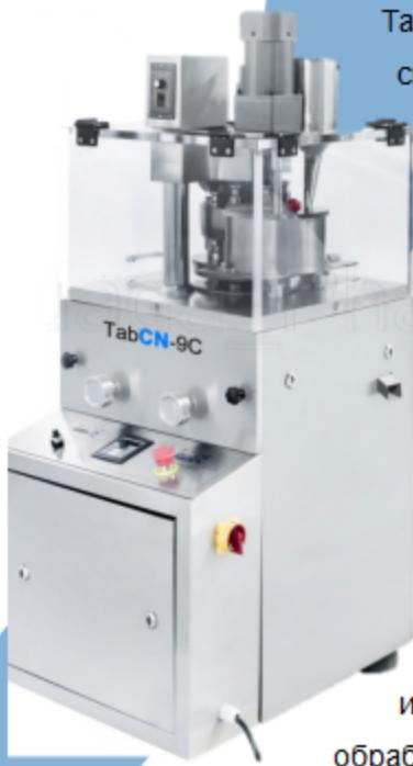
Tab CN - 5-7-9 C машина представляет собой односторонний таблеточный пресс, способный производить таблетки диаметром до 12 мм . При минимальных требованиях к обучению операторов и техническому обслуживанию машина представляет собой экономически эффективное решение для производства таблеток малыми и средними партиями.
