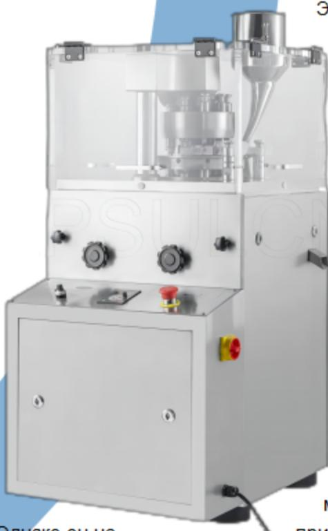
Электрический ротационный таблеточный пресс TabCN-9 pro представляет собой небольшую машину для прессования таблеток с автоматическим вращением и непрерывным прессованием таблеток. В пределах диапазона давления машины она может прессовать гранулированное сырье с содержанием порошка менее 10% в круглые таблетки специальной формы и с надписью размером 5~20 мм. Он в основном используется в фармацевтической, химической, пищевой, электронной и других отраслях промышленности.
