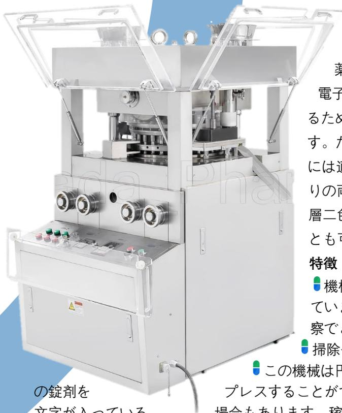
TabCN-29/31 ロータリー錠剤プレスは、自動回転、周波数制御、連続錠剤プレスを備えた一種の錠剤プレス機です。主に製薬業界における錠剤の製造に適用されます。さらに、化学、食品、電子およびその他の産業において、粒状の原材料を錠剤にプレスするために使用されます。粉体含有率 10%以下の粒状原料に適しています。ただし、半固体、湿った顆粒、湿りやすい粉体、融点の低い原料には適用できません。この機械は、丸錠、特殊な形状の錠剤、文字入りの両面錠をプレスすることができます。4~18mm のリング錠と二層二色錠。また、ご要望に応じて 20mm 以内の錠剤をプレスすることも可能です。
