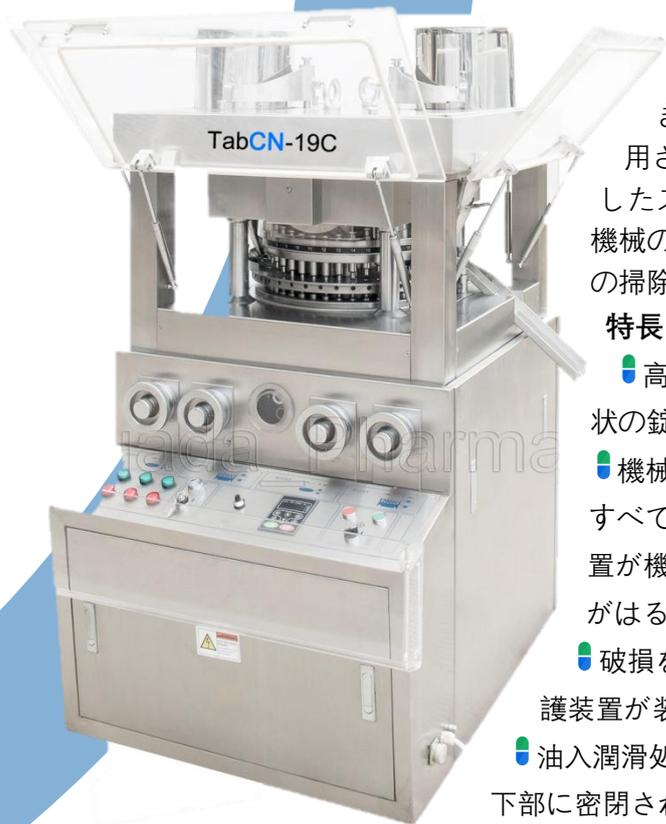
自動回転・連続打錠機を備えた単圧式の機械で、粒状原料を一般錠剤から特殊形状の錠剤まで各種打錠することができます。主にエレクトロニクス、食品、日用品、製薬業界で使用されています。全密閉型の外側ハウジングは GMP 規格に準拠したステンレス製です。また、透明な観察窓が装備されているため、機械の動作状態を明確に観察できます。また、開閉できるので内部の掃除やメンテナンスも簡単に行えます。
