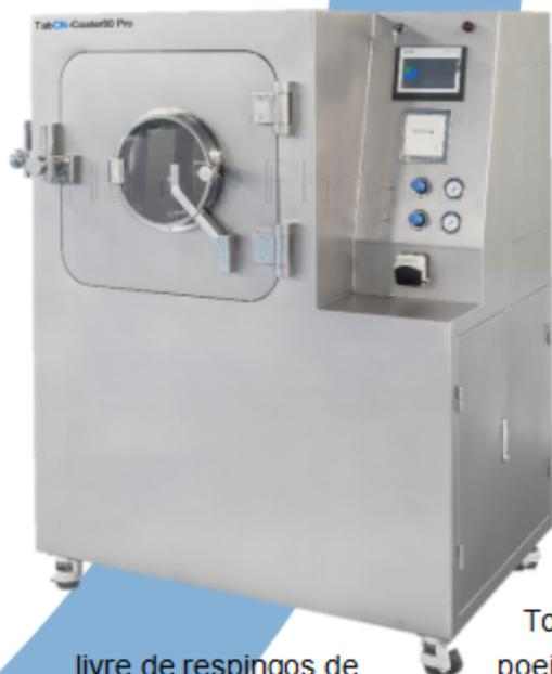
A máquina de revestimento eficiente é um equipamento experimental para uso especial amplamente aplicado em comprimidos chineses e ocidentais, pílulas e similares para a realização de fase aquosa e revestimento de filme orgânico.
