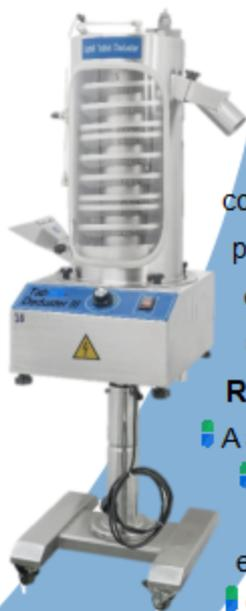
O TabCN-Deduster III Pro Uphill Tablet De-duster é um equipamento especial para limpar rebarbas e poeira do comprimido durante a subida. Pode ser conectado com prensa de comprimidos e sistemas de detecção de metais. A função da máquina é remover, levantar e peneirar o pó de comprimidos. O aço inoxidável 316L é usado para todas as peças de metal em contato com os comprimidos que estão de acordo com o padrão GMP. É amplamente utilizado nas indústrias, como química, alimentos. etc.
