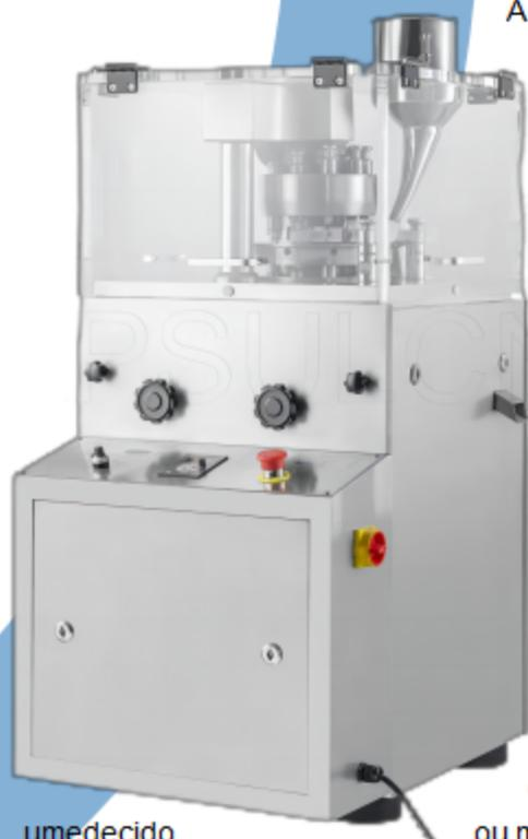
A prensa rotativa elétrica para comprimidos TabCN-9 pro é uma pequena máquina de prensagem de comprimidos com rotação automática e prensagem contínua de comprimidos. Dentro da faixa de pressão da máquina, ela pode pressionar matérias-primas granulares com teor de pó inferior a 10% em comprimidos redondos, de formato especial e com letras de 5 a 20 mm. É usado principalmente em indústrias farmacêuticas, químicas, alimentícias, eletrônicas e outras.
